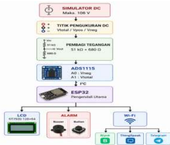
Gambar 9. Integrasi Keseluruhan Perangkat Keras
