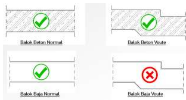
Gambar 1 Perbedaan Struktur Beton dan Baja
