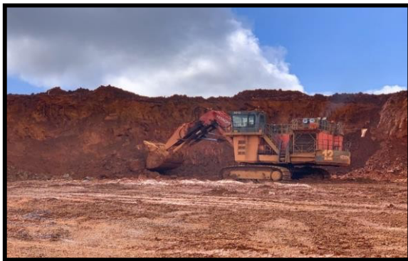
Gambar 3. Proses kegiatan pengupasan tanah penutup (stripping)
