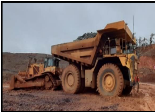
Gambar 16. Jarak antar dozer dan dump truck terlalu dekat.
