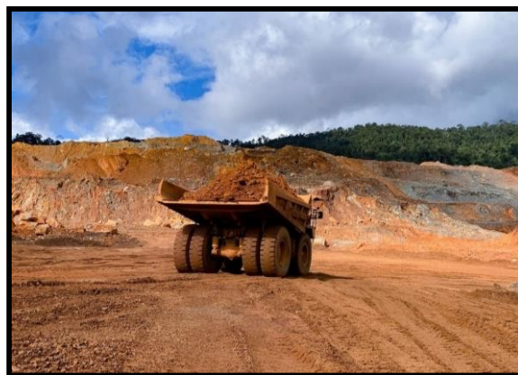
Gambar 6. Proses kegiatan pengangkutan ke stockpile (hauling)
