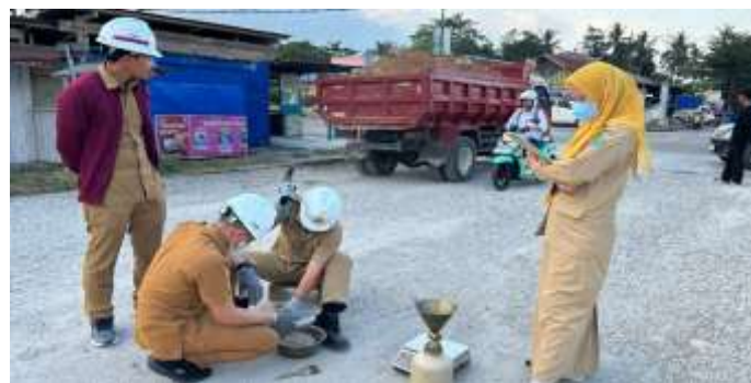
Gambar 2 Pengujian Sand Cone Lapis Pondasi Kelas A. Ruas jalan Kalenggo Kec. Unaaha Kab. Konawe Sumber : Dinas PUPR Konawe (2026)
