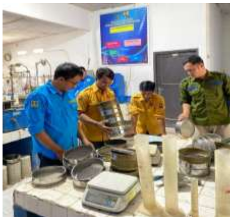
Gambar 3 Pemeriksaan agregat dengan analisa saringan pada UPTD Laboratorium Konstruksi Dinas Pekerjaan Umum dan Penataan Ruang Kabupaten Konawe Sumber : Dinas PUPR Konawe (2026)
