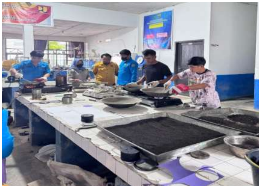
Gambar 1 Pembuatan Job Mix Design Aspal pada UPTD Laboratorium Konstruksi Dinas Pekerjaan Umum dan Penataan Ruang Kabupaten Konawe Sumber : Dinas PUPR Konawe (2026)
