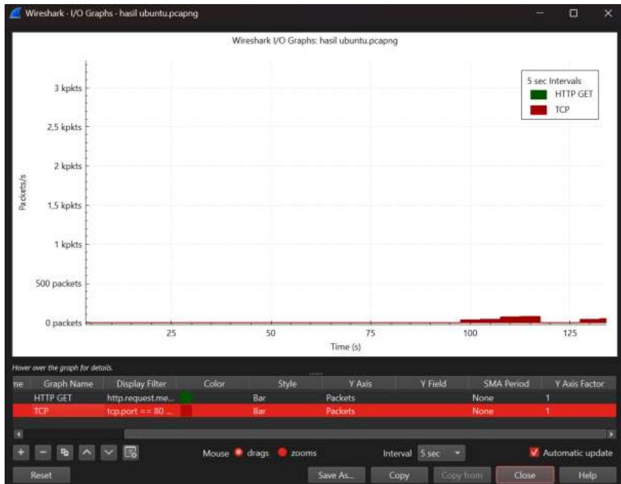
Gambar 2. Grafik Konsumsi Koneksi Stabil Rendah (I/O Graph) pada Serangan Slowloris
