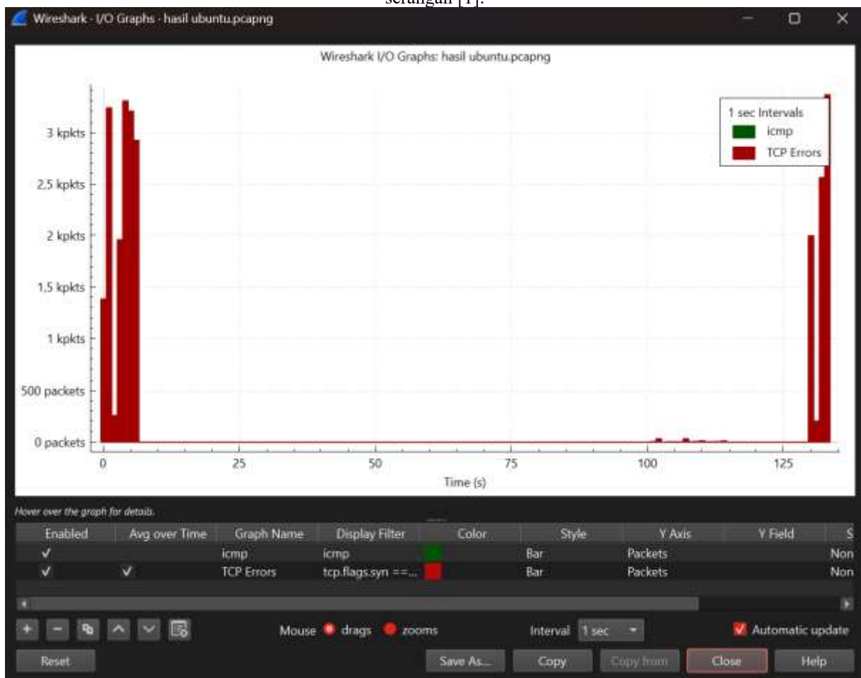
Gambar 1. Grafik Lonjakan Trafik Data (I/O Graph) pada Serangan SYN dan ICMP Flood
