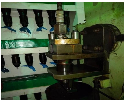
Gambar 4. Pengetesan Injektor Sumber: Penulis (2023)
