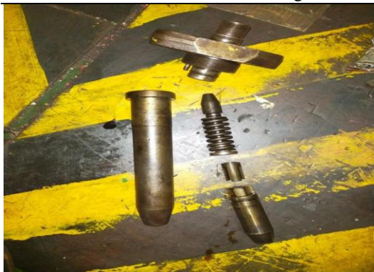
Gambar 3. Pengecekan Komponen Injektor Sumber: Penulis (2023)
