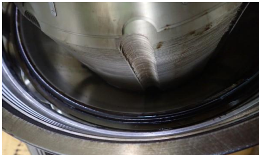
Gambar 6. Pemasangan Bowl Disc
