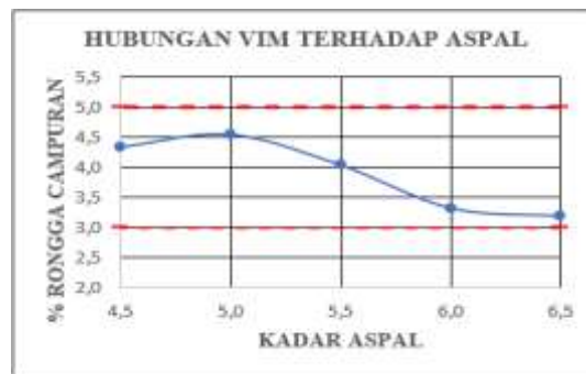
Gambar 4. 4 Hubungan VIM Terhadap Kadar Aspal Sumber : Hasil Penelitian Laboratorium Teknik Sipil Unihaz, 2025
