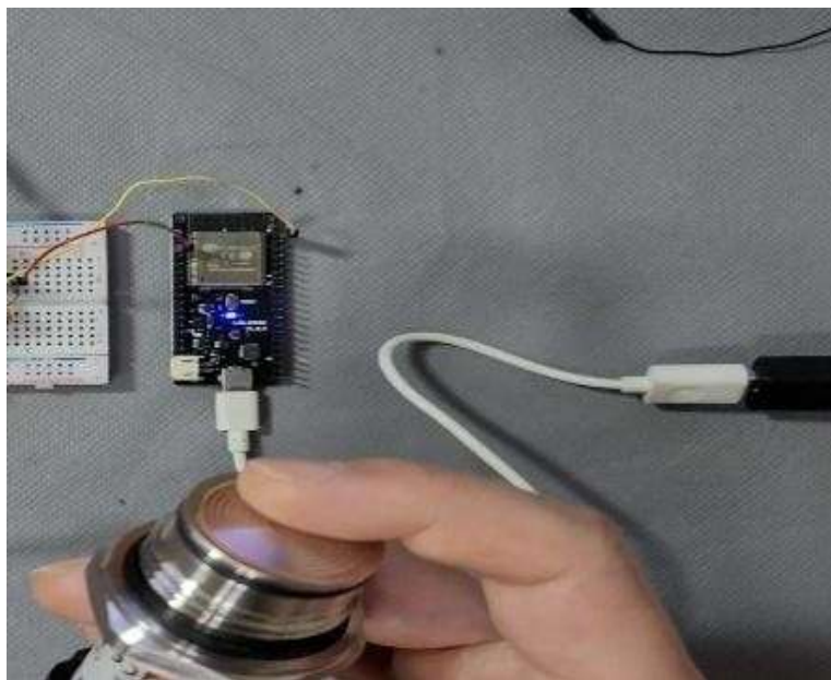
Gambar 2. : Pengujian Pressure Transmitter
