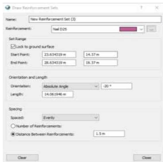
Gambar 7. Input pemodelan Stabilitas lereng dengan kondisi perkuatan Soil Nailing
