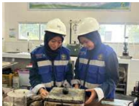
Gambar 5. Pengujian Berat Jenis Aspal (Sumber: Dokumentasi Pribadi)
