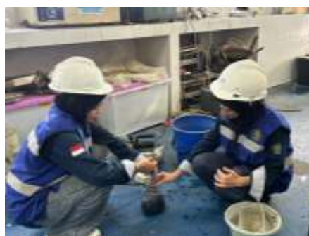
Gambar 1. Pengujian GMM (Sumber: Dokumentasi Pribadi)
