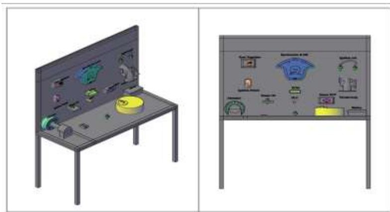
Gambar 2. Desain Media pembelajaran Simulator Sistem Injeksi Bahan Bakar
