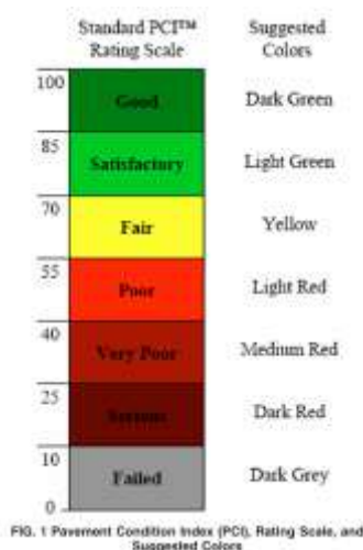
Gambar 1. Indeks Kondisi Perkerasan (PCI) penilaian dan warna
