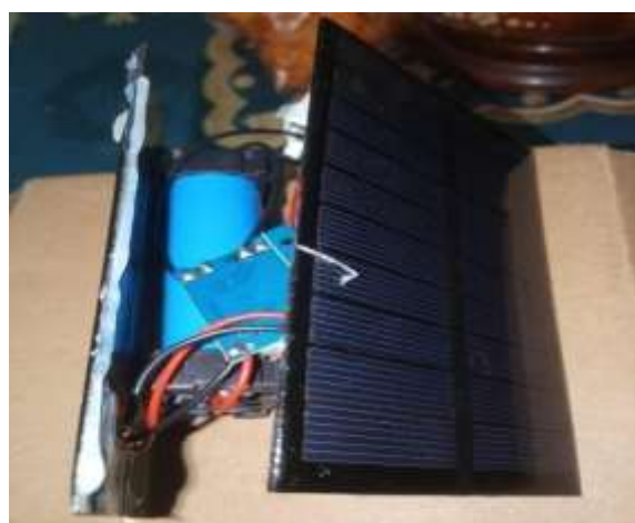
Gambar 3.3 rancangan sumber tegangan panel surya
