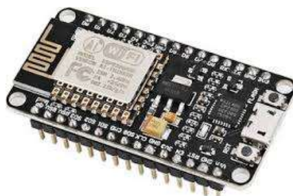
Gambar 5 NodeMCU ESP8266 yang digunakan dalam system absensi
