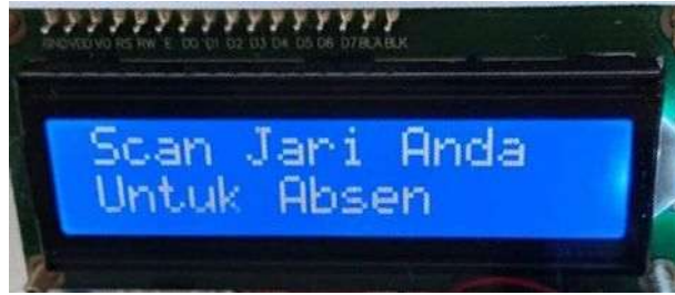
Gambar 7 LCD 16x2 Menampilkan Status
