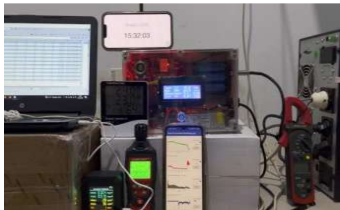
Gambar 6 Pengujian Sensor SEMS terhadap Parameter Suhu, Kelembapan, Gas, dan Arus di Ruang Server
