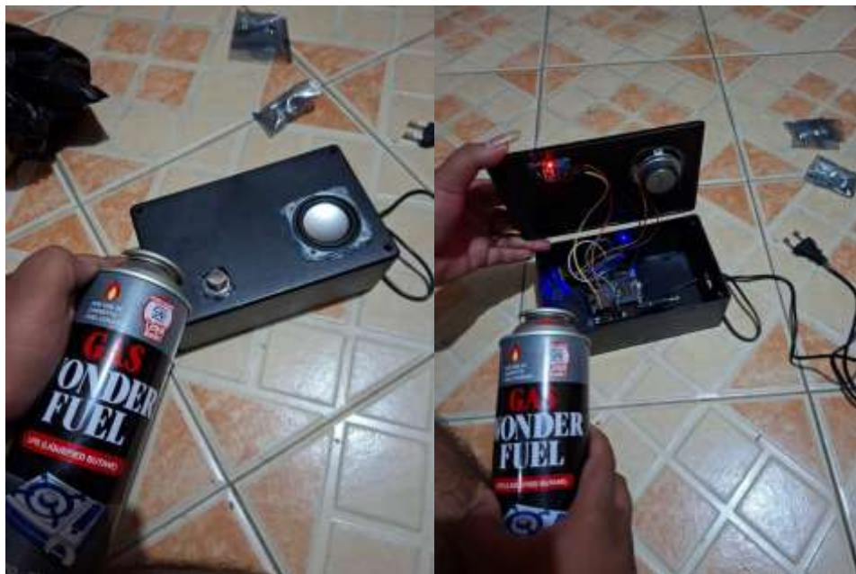
Gambar 9. Pengujian Sensor MQ-2 Menggunakan Gas
