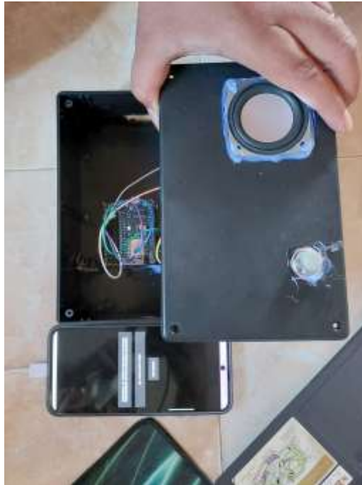
Gambar 10. Pengujian Pendeteksi Gas Melalui Smartphone
