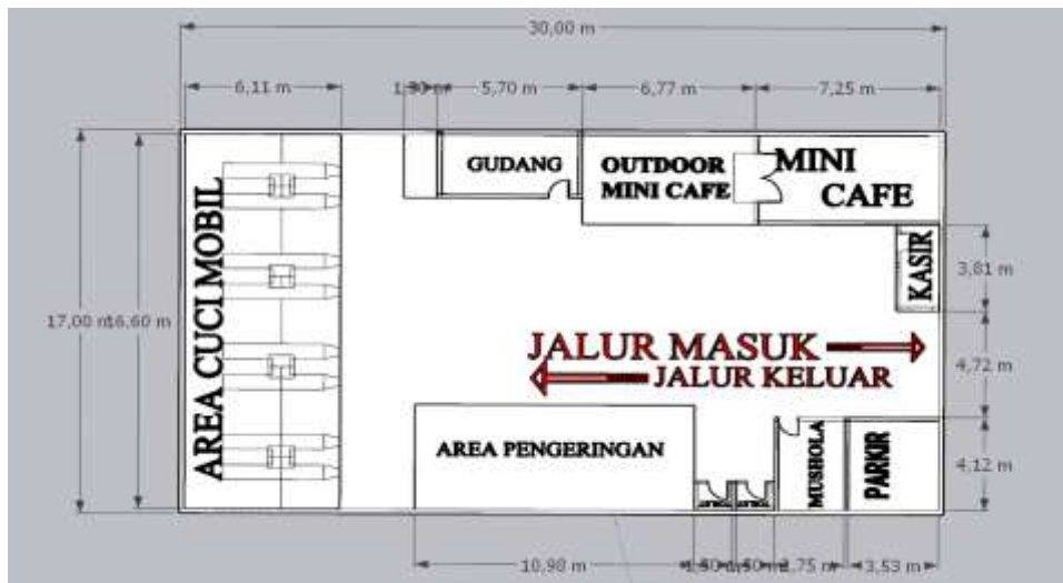
Gambar 15. Alternatif Layout Kedua Carwash (Sumber: M. Muammar Shiddiqi, 2025)
