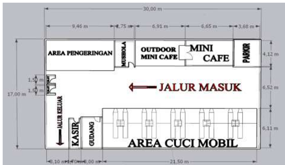
Gambar 14. Alternatif Layout Pertama Carwash (Sumber: M. Muammar Shiddiqi, 2025)
