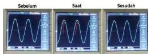
Gambar 20 Bentuk Gelombang Output Sebelum, Saat, dan Sesudah Perpindahan ATS Pada Uji Kelima
