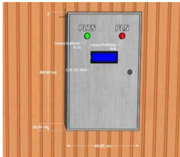
Gambar 1 Desain 3D Panel ATS Tampak Depan
