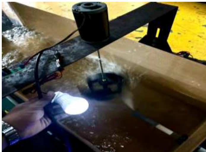
Gambar 8. Pengujian Generator Pertama Dengan Lampu DC Sumber : Dokumen Pribadi
