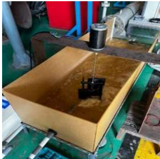
Gambar 6. Pengujian Generator Pertama Tanpa Beban
