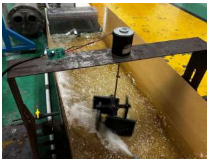
Gambar 7. Pengujian Generator Kedua Tanpa Beban
