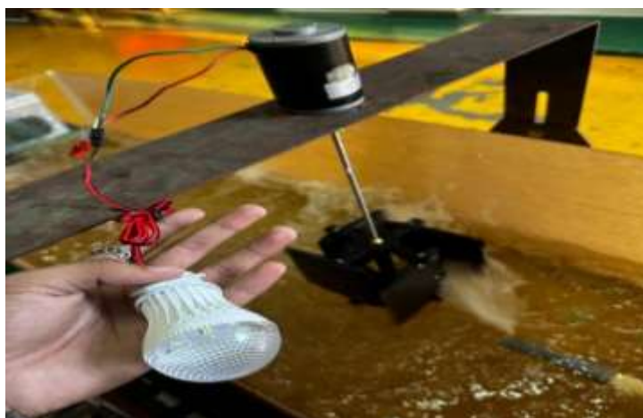
Gambar 9. Pengujian Generator Kedua Dengan Lampu DC
