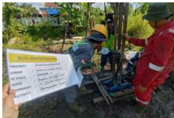
Gambar 2. Pengukuran sondir di lokasi penelitian.
