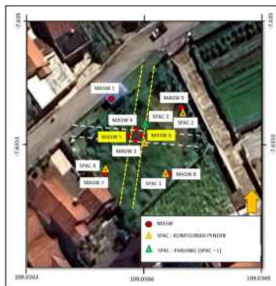
Gambar 3. Titik pengukuran dan desain survei mikrozonasi.
