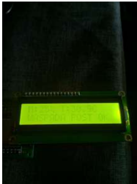
Gambar 3. Tampilan kelembaban, suhu, dan status pada LCD
