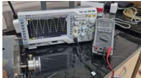
Gambar 7. Pengujian Generator Menggunakan Osiloskop
