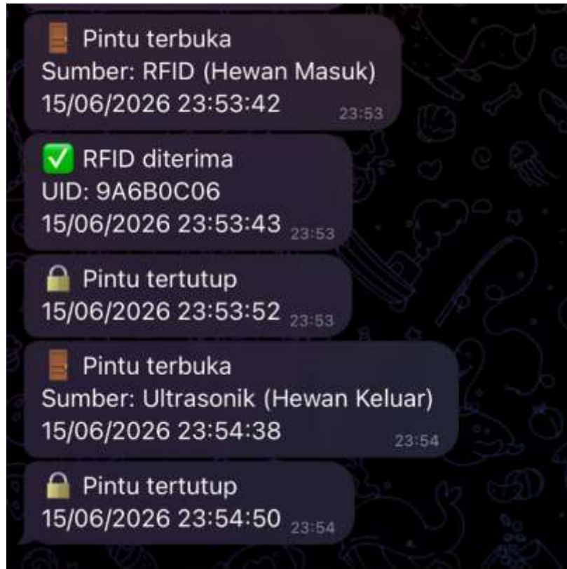
Gambar 6. Tampilan notifikasi Telegram yang diterima pengguna ketika sistem mendeteksi aktivitas akses masuk, akses keluar, dan penutupan pintu.
