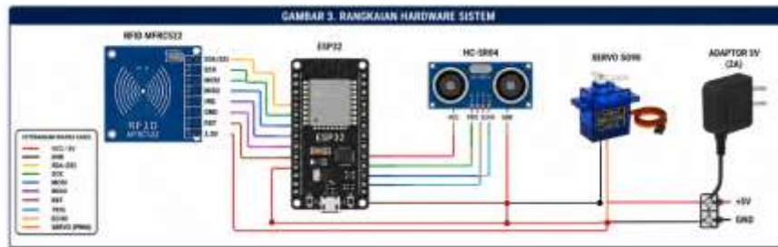
Gambar 3. Rangkaian perangkat keras yang menunjukkan koneksi ESP32 dengan RFID MFRC522, sensor ultrasonik HC-SR04, motor servo SG90, dan adaptor catu daya 5V.
