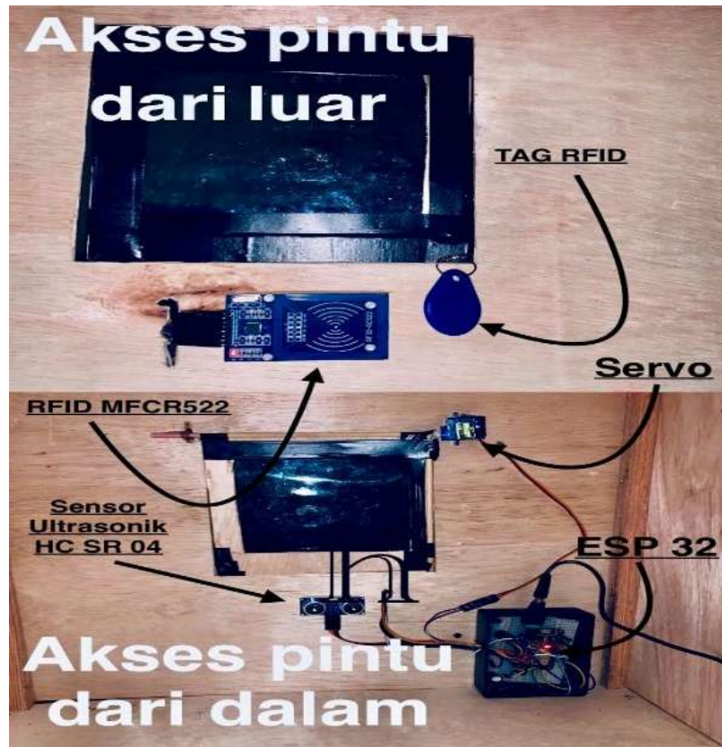
Gambar 5. Implementasi prototipe sistem pintu otomatis hewan peliharaan yang terdiri atas ESP32, RFID MFRC522, sensor ultrasonik HC-SR04, motor servo, dan pintu prototipe.
