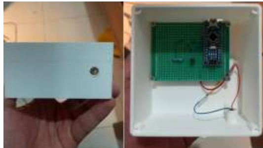
Gambar 9. Pemasangan Komponen Kedalam Box Cover
