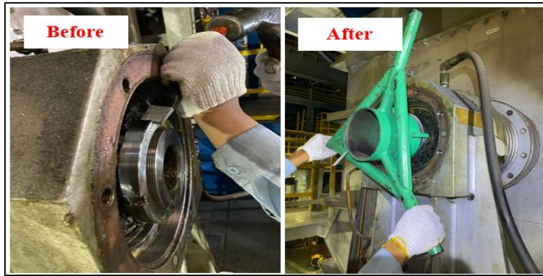
Gambar 6. Implementasi Jig Pada Proses Melepas Lock Nut
