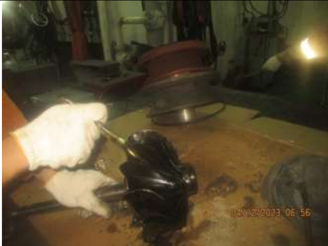
Gambar 2. Inspeksi Turbin Dan Blower Side Sumber: Dokumen Pribadi (2023)
